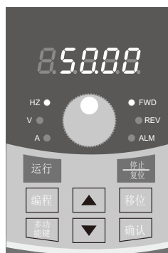
图 4-4 运行参数显示状态 显示运行时输出频率“50.00”
