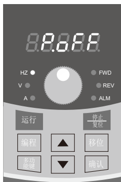
图 4-2 上电参数显示状态 上电初始化，显示“P.oFF”
