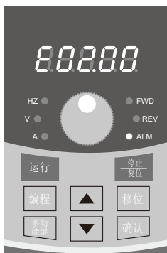
图 4-5 加速中过流故障报警显示
