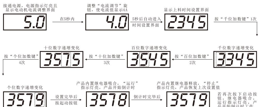
3、若需重新设定工作时间，按下停止按钮将产品切换到停止状态即可设定。
