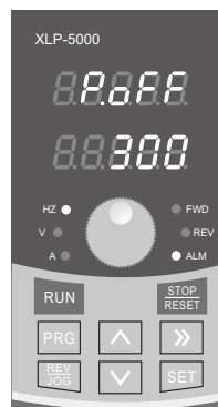
图4-2 上电参数显示状态 上电初始化，显示“P. oFF”
